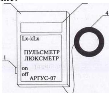
Рис. 3. Внешний вид люксметра-пульсометра «Аргус-07»
