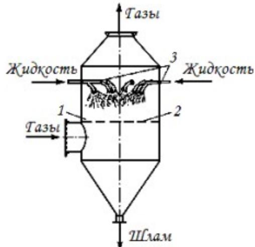
2. Дополните схему работы и устройства полого распылительного скруббера-пылеуловителя:
