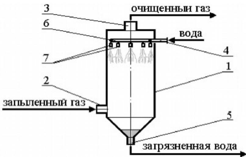
3. Дополните схему работы и устройства скруббера-пылеуловителя Вентури:
