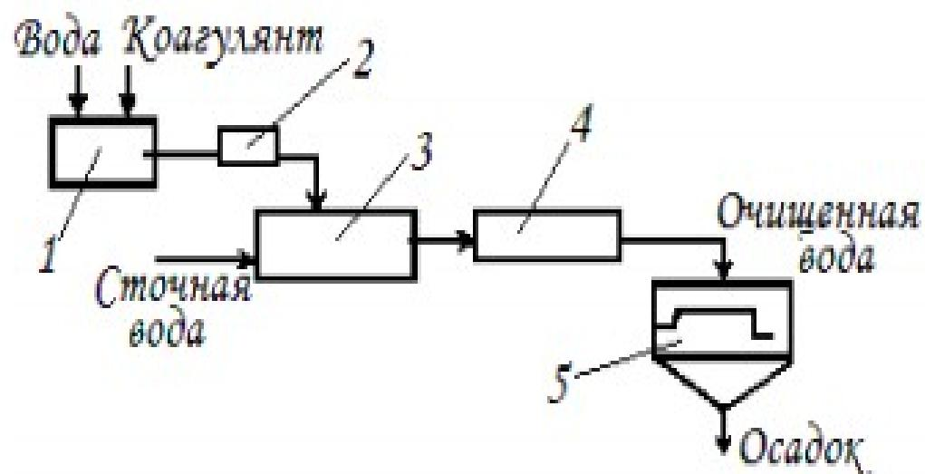
3. Дополните схему работы и устройства установки напорной флотации:
