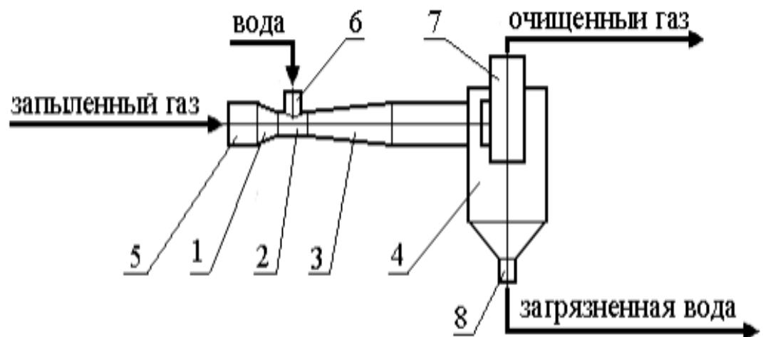
4. Дополните схему работы и устройства насадочного скруббера-пылеуловителя:
