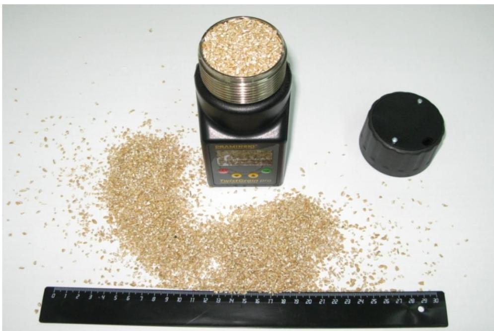
Рис.7. Определение влажности пшеничной дерти
