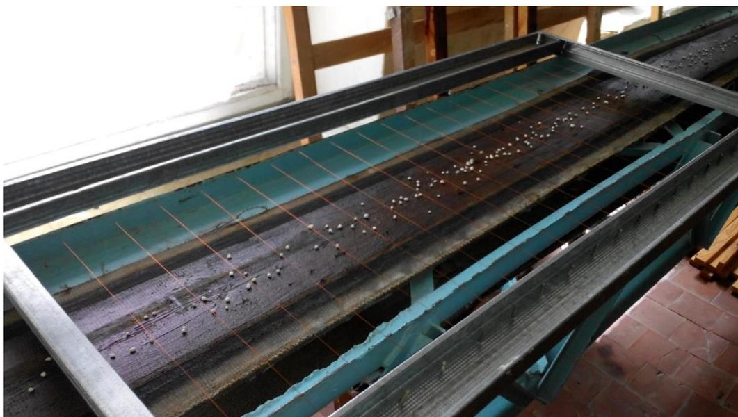
Рис. 5. Исследование на равномерность с помощью подвижной рамки
