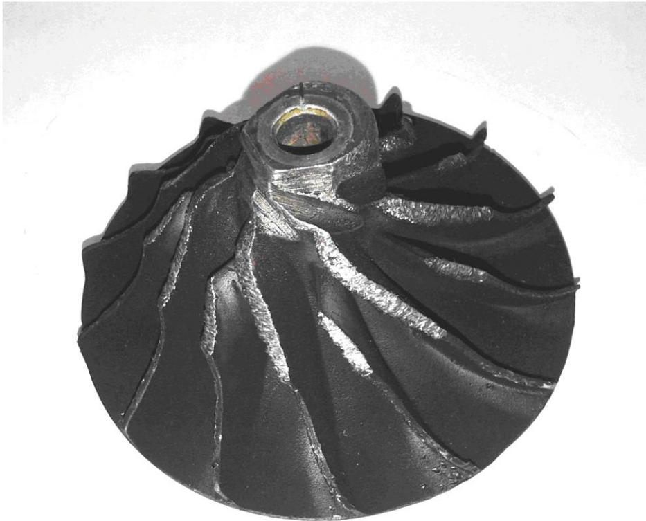
Рис. 1. Крыльчатка, поврежденная в результате попадания посторонних предметов
