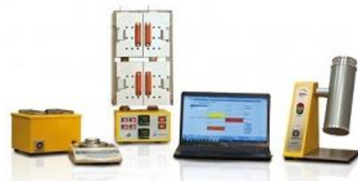
Рис. 1. Метод воздушно-тепловой сушки, охладитель АО-3, лабораторные весы VIBRA модель AGE-320, сушильный шкаф АСЭШ-8-1, лабораторная мельница серии «Вьюга»
