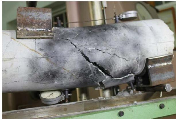
Рис. 1. Колонна кругового сечения после проведения испытаний
