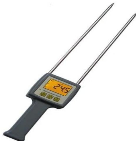
Рис. 3. Кондуктометрический метод, ТК25G
