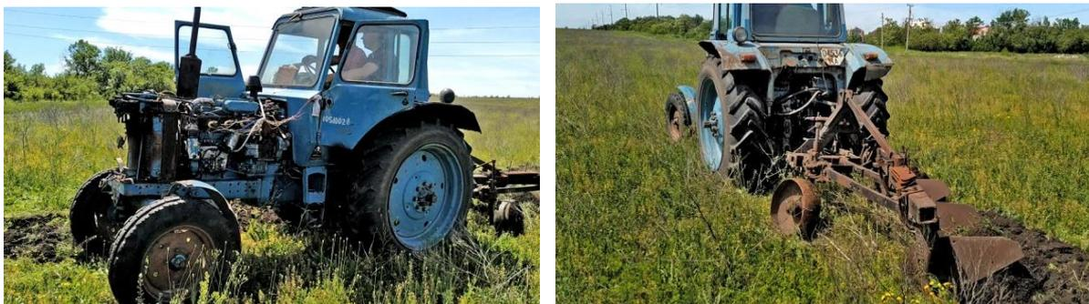
Рис. 1. Общий вид МТА в составе трактора МТЗ-80 и плуга ПЛН -3-35
