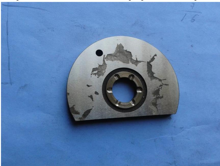
Рис. 4. Следы повреждений упорного подшипника агрессивными добавками в масле
