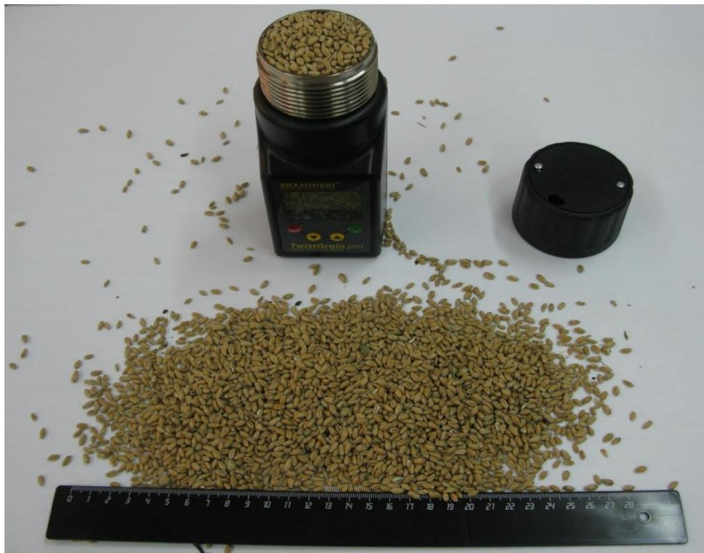
Рис.6. Определение влажности пшеницы
