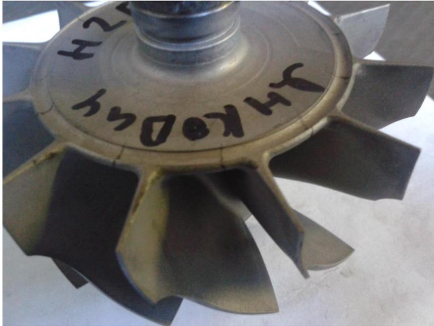
Рис. 5. Ротор со следами потертости и трещинами на крыльчатке
