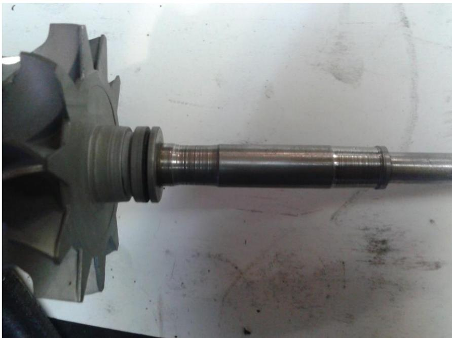
Рис. 2. Ротор турбокомпрессора, работавшего на масле плохого качества
