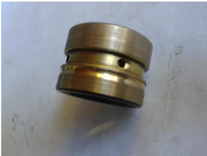
Рис. 3. Износ радиального подшипника при работе на загрязненном масле
