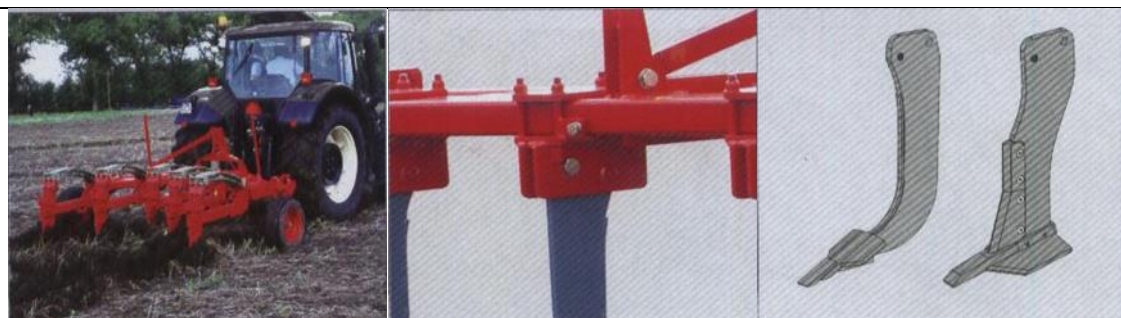
Рис.6.1.6.25. Навесной глубокорыхлитель-чизель UNIA Kret B 5
