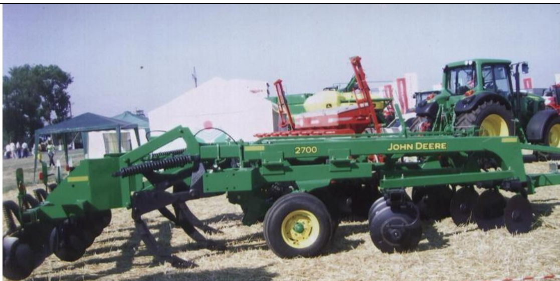
Рис. 6.6.1.24. Рыхлитель для мульчированного слоя John Deere 2700, разрыхляет «плужную подошву» на глубину до 40 см.
