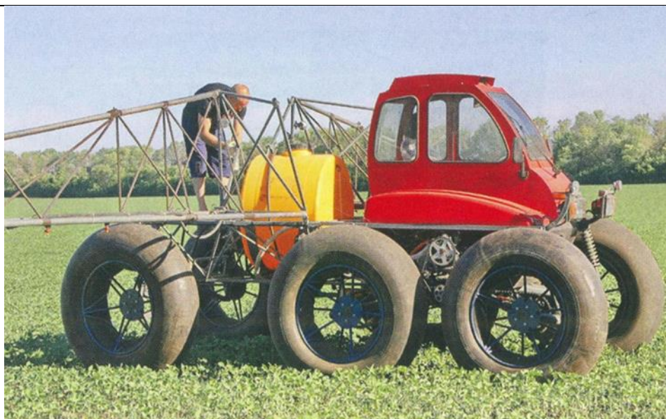
Рис. 6.1.1.13. Внесение удобрений агрегатом на шинах сверхнизкого давления комплекс “Роса” (Беларусь)
