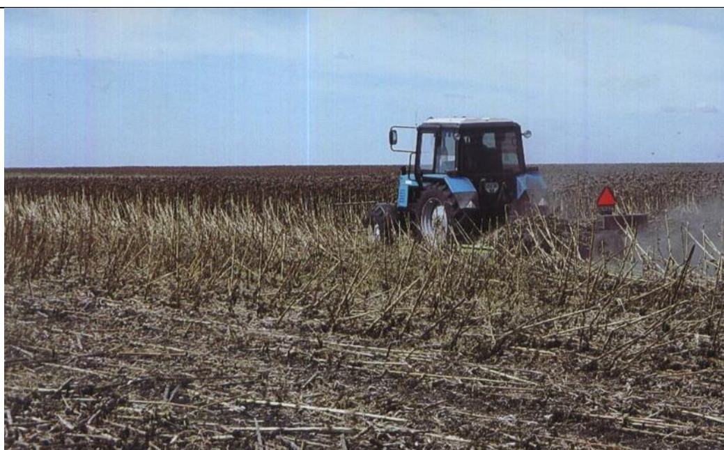
Рис. 6.1.1.5. Роторный измельчитель Schulte S150.
