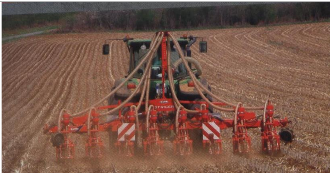
Рис.6.6.1.19. Агрегат для работы по технологии Strip-till для внесения сухих минеральных удобрений
