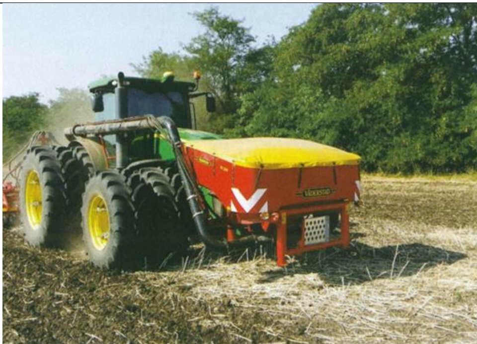
Рис. 6.1.1.11. Агрегат выполняет равномерное рыхление почвы и локальное внесение удобрений, “Трударь”.
