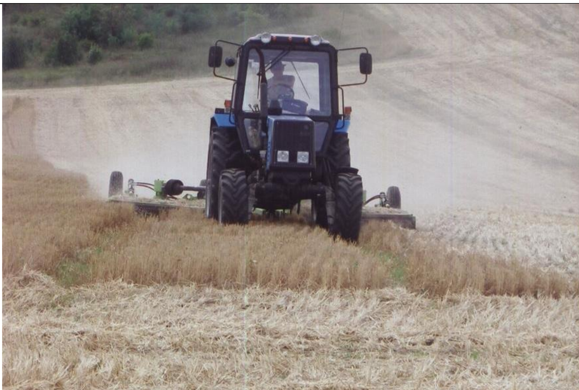
Рис. 6.1.1.4. Роторный измельчитель Schulte S150.
