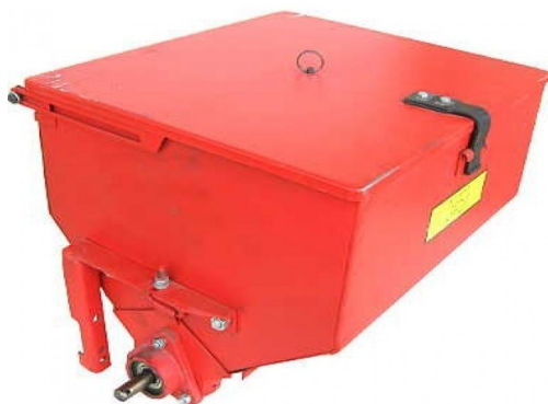
Рисунок 1 – Аппарат туковывсевающий (банка туковая) металл
