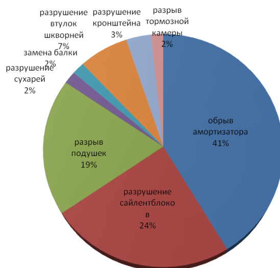
Рисунок 5 – Структура потока отказов по подвеске автобусов [4]
