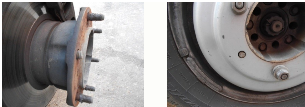
Рисунок 2 – Обрыв шпилек при неправильной затяжке
