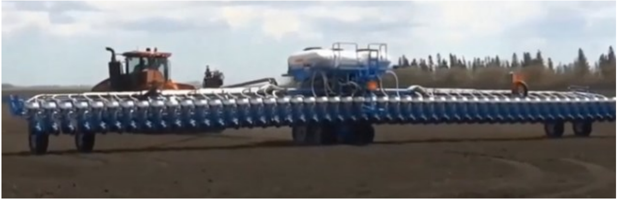
Рисунок 7 – Широкозахватный агрегат на базе овощной сеялки Monosem MS
