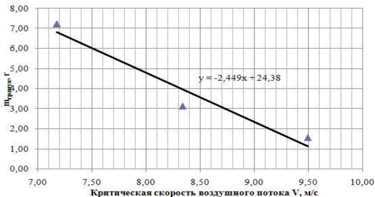
Рисунок 7 – Зависимость критической скорости воздушного потока V от массы гранул m_{\text{гранул}}
