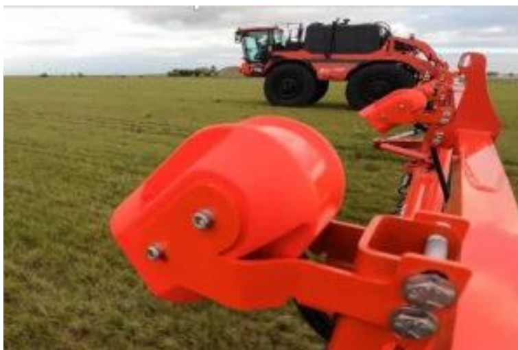
Рисунок 3 – Датчики для обнаружения сорняков, установленные на штанге опрыскивателя [6]
