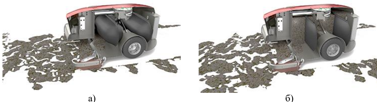
Рисунок 9 - Робот Lely Discovery 120 Collector уборки навоза для сплошных полов (Нидерланды): а) в начале работы (емкости с водой наполнены); б) в конце работы (емкости с водой опустошены) [8].
