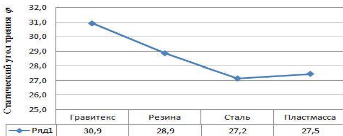
Рисунок 4 – Зависимость статистического угла трения ФВУ смеси в зависимости от материала поверхности
