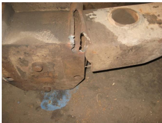
Рисунок 3 – Разрыв балки заднего моста при эксплуатации подвески в критических условиях эксплуатации
