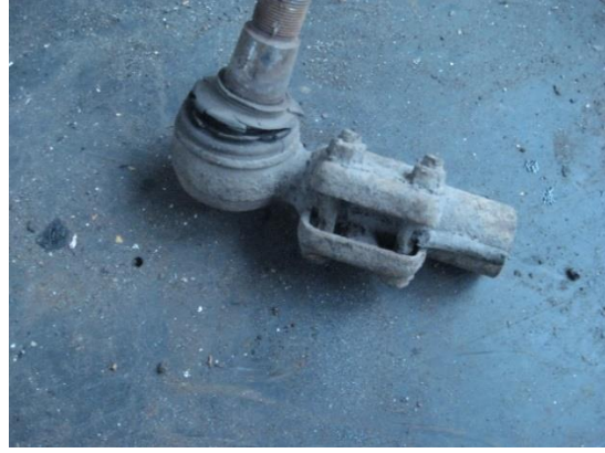
Рисунок 4 – Разрыв сайлентблоков и пыльников при эксплуатации подвески в критических условиях эксплуатации
