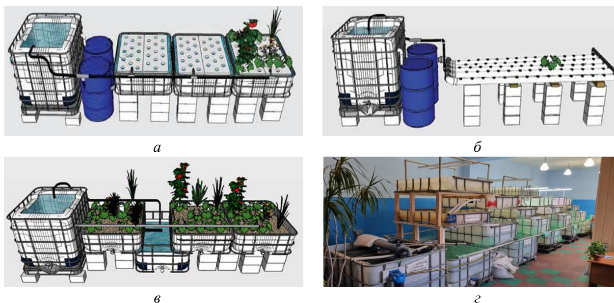
Рисунок 1 – Аквапоника по методу: а – глубоководной культуры (DWC); б – питательной плёнки (NFT); в – гравийного пласта (the media bed); г – ярусная установка
