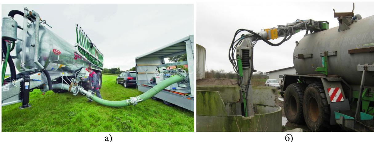
Рисунок 5 – Устройства для транспортировки навоза с установленными сенсорами на основе СвБИО [6]: а) «NutrientContent-Lab» (NCL) 2.0 ‘Kotte Landtechnik GmbH (Deutschland); б) Van-Control 2.0 Zunhammer GmbH (Deutschland).
