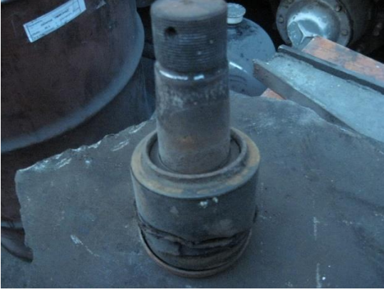
Рисунок 4 – Разрыв сайлентблоков и пыльников при эксплуатации подвески в критических условиях эксплуатации
