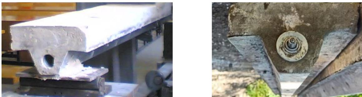
Рисунок 2 – Фрагмент плиты до и после предварительного напряжения арматуры
