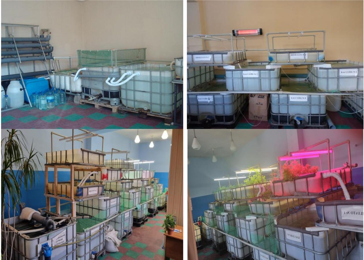
Рисунок 1 — Опытные образцы одно- (вверху слева), трех- (вверху справа), пяти- (внизу слева) ярусных и действующая четырех ярусная (внизу справа) установки замкнутого водоснабжения
