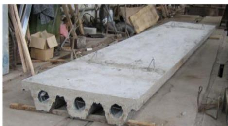
Рисунок 3 – Пустотно ребристая плита после преднапряжения арматуры
