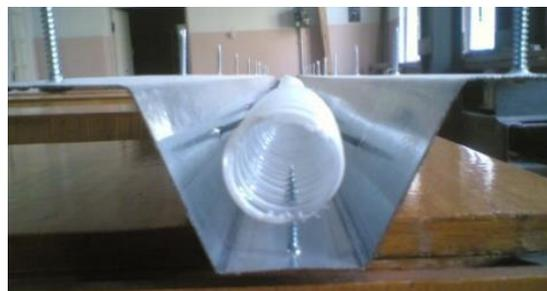
Рисунок 1 – Опалубка фрагментов плит с внешним армированием и крепление каналов преднапрягаемой арматуры саморезами
